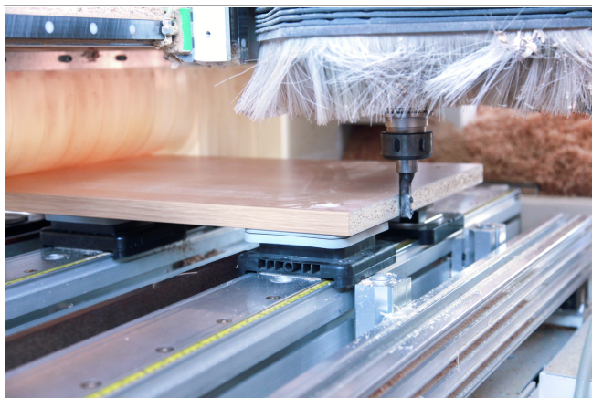
Блочная присоска VCBL-S для эксплуатации на консолях SCM
